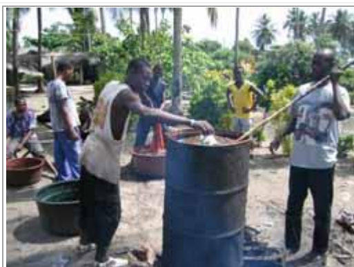
La cire remonte à la surface et doit être enlevée.
